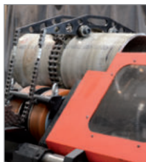
DCS-0436-99-00-00-0 Dispositivo di serraggio per tubi corti di lunghezza 400-830mm
