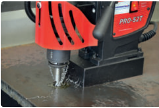
Maschiatura fori passanti sino a M20
