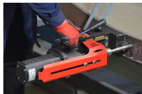
Capacità di foratura con punte elicoidali sino a 18 mm
