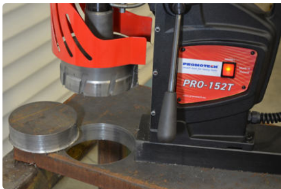
Foratura con frese a corona max 150 mm
