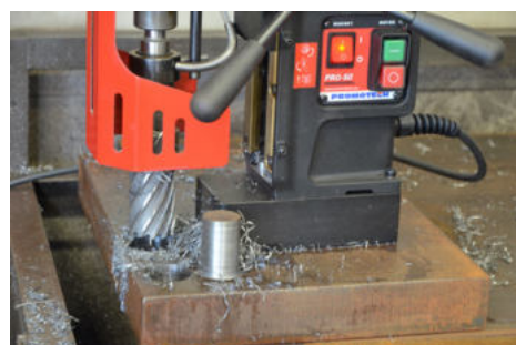
Foratura con frese a corona sino a 50 mm Profondità massima fino a 75 mm
