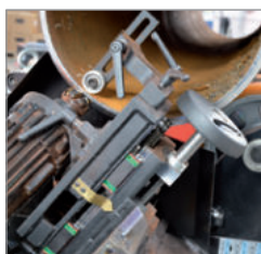
WSP-0436-24-00-00-0 Fissaggio della guida per tubi ovali Disponibile sia per macchine nuove o per retrofit
