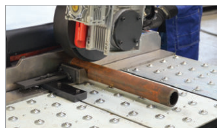
Possibilità di smussatura del diametro esterno
