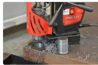
Foratura con frese a corona sino a 70 mm Profondità max. sino a 75 mm
