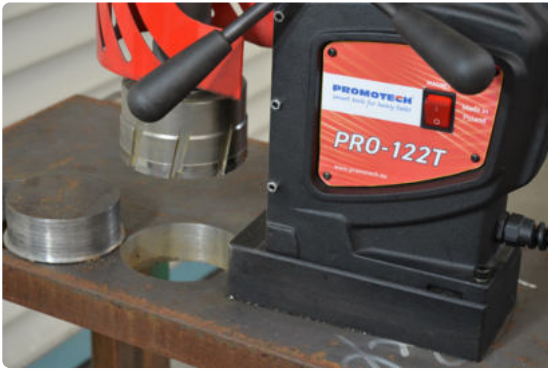
Capacità di foratura con frese a corona sino a 120 mm
