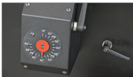
Regolazione precisa dell'angolo di smusso
