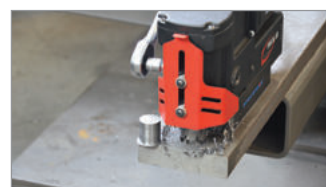
Capacità max di fresatura fino a 36 mm
