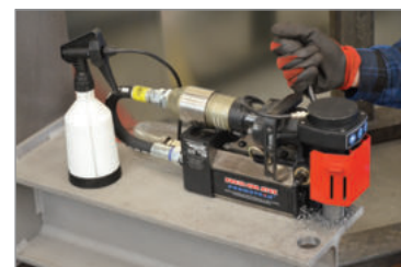
Sistema di raffreddamento attraverso il mandrino
