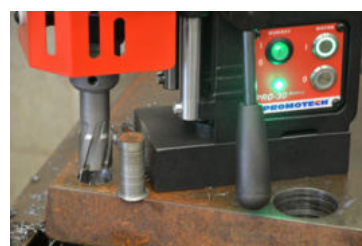
Foratura con frese a corona sino a 30 mm • Profondità max. sino a 50 mm
