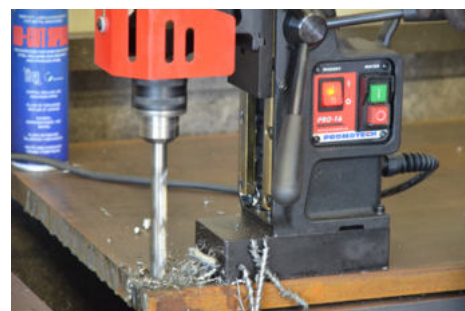
Capacità di foratura con punte elicoidali sino a 16 mm
