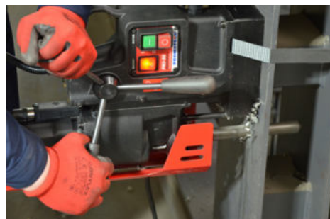
Capacità di foratura con punte elicoidali sino a 23 mm
