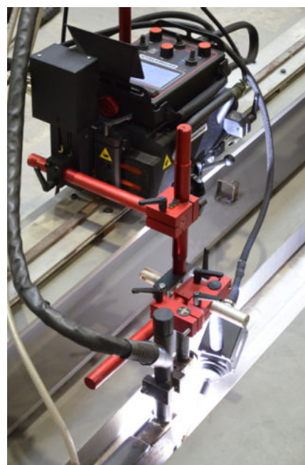
Il sistema segui giunto funziona anche con oscillazione attiva
