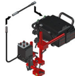
Cavo segnale per collegamento Rail Titan ed oscillatore a pendolo OSC-8 PWD-0654-10-00-00-0
