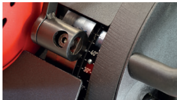
Impostazione precisa dell'angolo di smussatura
