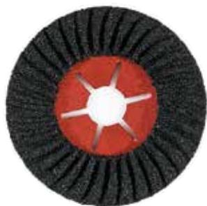
Disco semiflessibile al carburo di silicio. Lo speciale supporto in fibra su cui è applicato il materiale abrasivo, conferisce al disco un elevato grado di elasticità. Il disco è dotato di fori di aerazione. Buona capacità di asportazione anche esercitando poca pressione sul disco. Campi di applicazione: ideale per lavorazioni su materiali da costruzione - marmi, pietre, pvc, alluminio e cemento.
